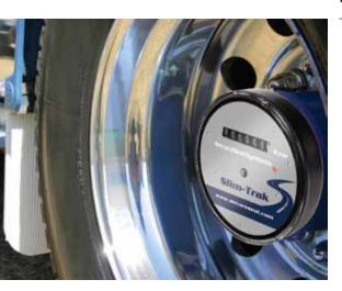
Aufzeichnung der zurückgelegten Kilometer mit dem Slim-Trak Hubodometer
